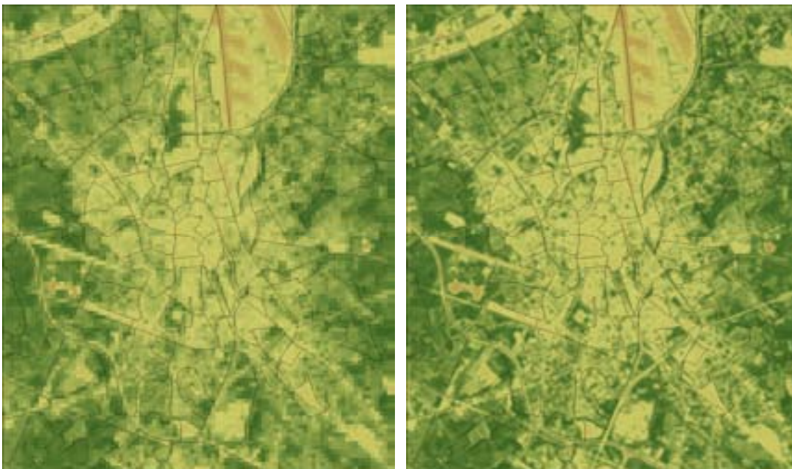
Figuur 86 : Vergelijking tussen het originele Landsat NDVI beeld (rechts, 30 m resolutie) en het gedownsamplede beeld naar de ASTER resolutie (links, 90 m).
