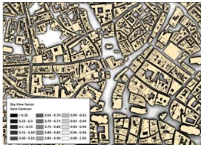
Figuur 77 : Voorbeeld van de afgeleide sky view factor voor een uitvergroting van het centrum van Gent. Men kan duidelijk de smalle straatjes met een lagere sky view factor zien en de eerder open pleinen met een hogere SVF.
