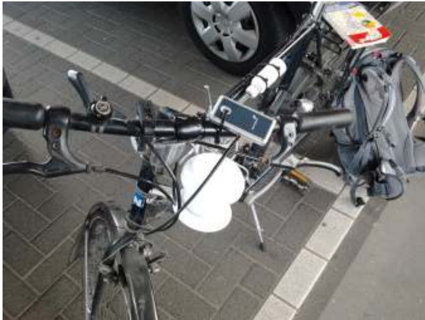
Figuur 39 : Foto van de HOBO U23 sensor vast gemaakt aan de fiets, samen met de GPS ontvanger die voor positiebepaling moet zorgen.
