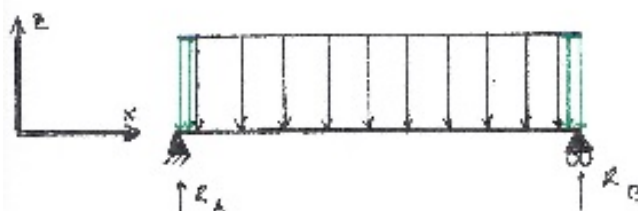
Figuur 3: Schematische voorstelling van de situatie. Zwart: werkelijke belasting. Groen: bijkomende belasting, waardoor volledig belast.
