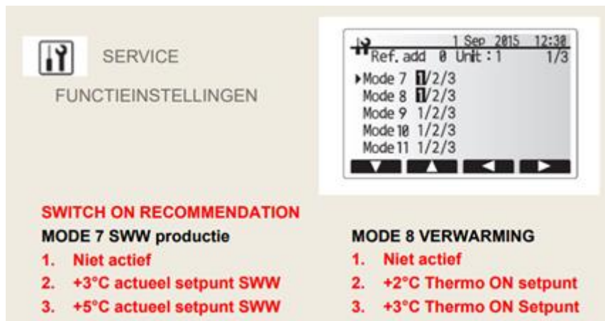
Figuur 71: Switch on recommendation setpunten.
