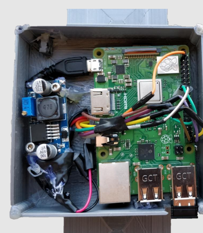
Binnenkant platform met raspberry pi
